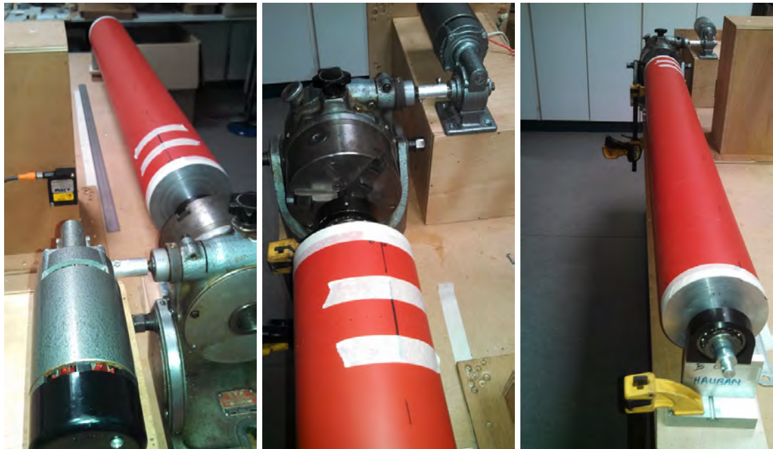
FIGURE 2.8 Montage de mesure du défaut de circularité
