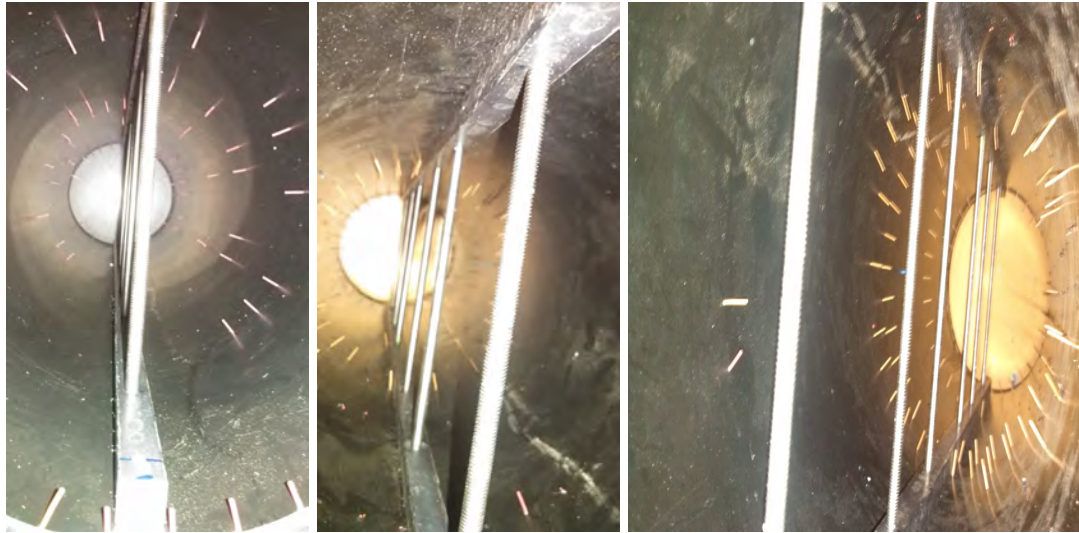
FIGURE 2.9 Montage de déformation de la gaine PEHD, D = 250mm
