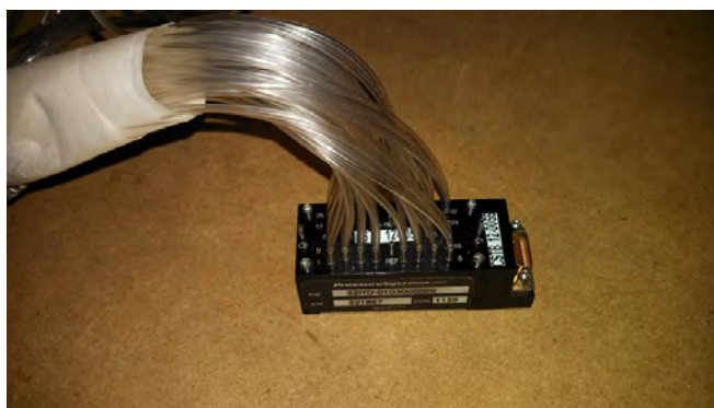
FIGURE 2.2 Un élément du scanner de pression PSI
