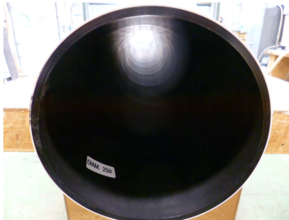
FIGURE 1.5 Gaine de protection PEHD extrudée, diamètre 250mm
