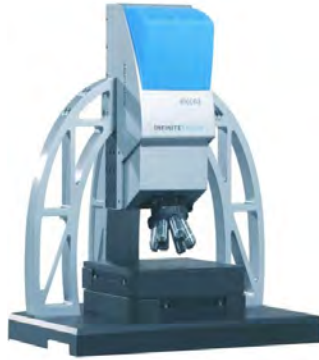
FIGURE 2.10 Rugosimètre optique utilisé pour la caractérisation des défauts microscopiques
