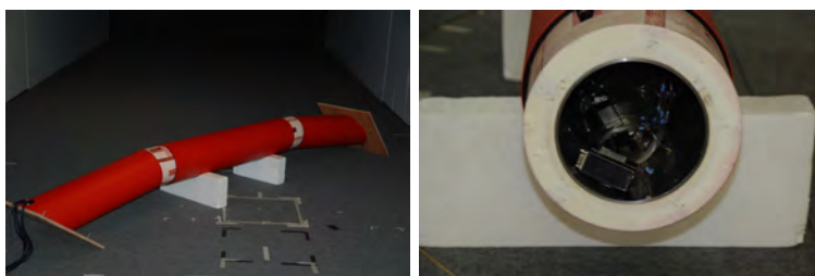
FIGURE 2.7 (Gauche) Composition d'une maquette en soufflerie. (Droite) Embout inséré à l'extrémité de la partie instrumentée sur une gaine de diamètre D = 250mm
