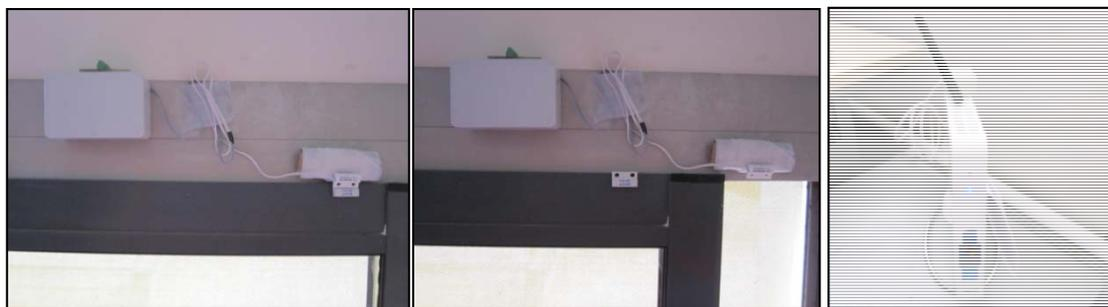
Figure 5 : Détecteur d'ouverture des fenêtres : à gauche, position fermée, au centre, position ouverte et à droite la CSTBox qui recueille l'ensemble des informations.
