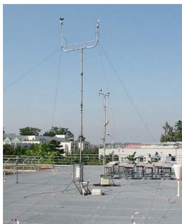
Figure 19 : Station permanente de mesure des paramètres climatiques sur le toit du bâtiment cible.
