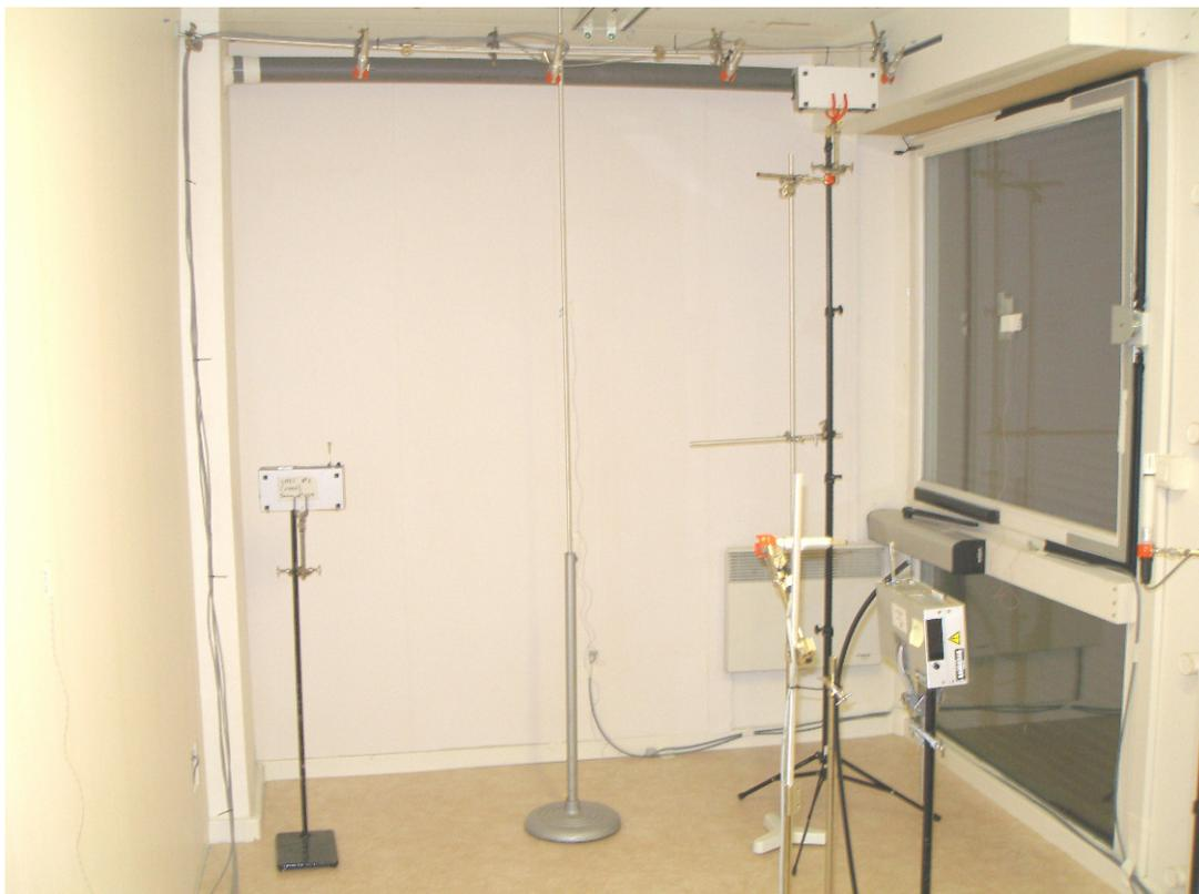
Figure 7 : Vue générale façade sud avec les 4 sondes de vitesse positionnées dans l'axe du soufflage et les 3 points de prélèvements entrée air (en haut à droite), face entrée air (à gauche de la phoyo) et centre (au premier plan).
