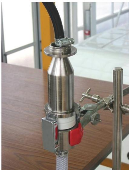
Figure 2-5 : Tête de prélèvement CATHIA reliée en partie haute à une des lignes de prélèvements situées sur la plateforme de l'enceinte expérimentale et en partie basse à la pompe de prélèvement
