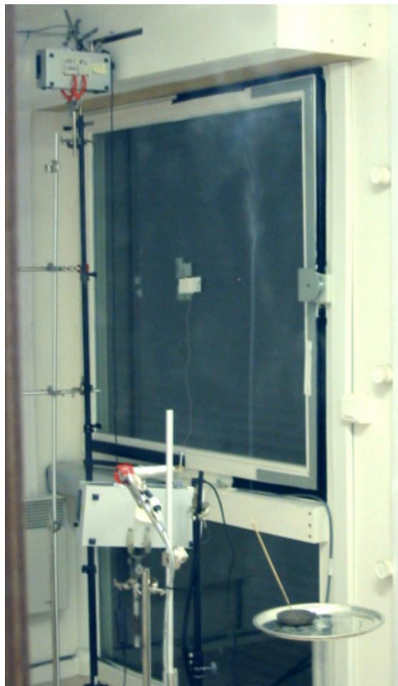
Figure 17 : Vue générale de la combustion d'un bâtonnet d'encens dans le volume.
