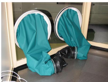
Figure 2-4 : Gants de manipulation permettant de simuler les activités sans perturber le milieu.
