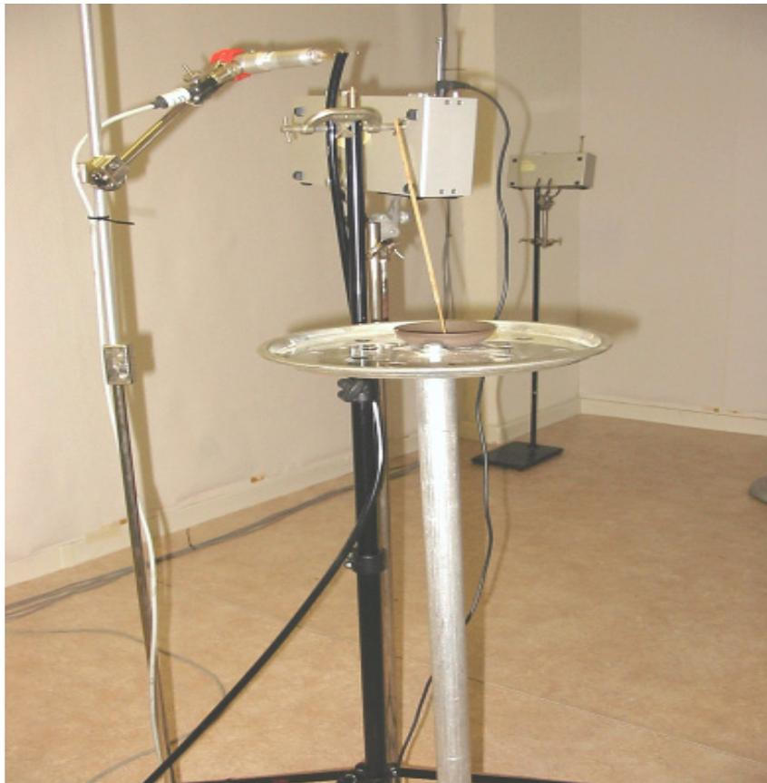
Figure 11 : bâtonnet d'encens et dispositif de prélèvement pour mesurage des concentrations de particules au centre de la chambre étudiée.
