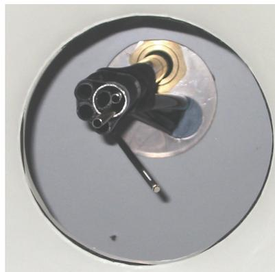
Figure 2-20 : Lignes de prélèvements vues de l'intérieur de l'enceinte (détail). Une sonde de température et d'humidité est disposée en retrait du prélèvement.
