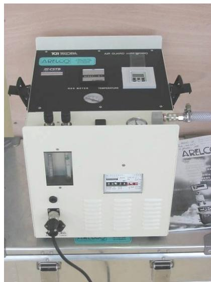
Figure 2-6 : Pompe de prélèvement BRAVO posée au pied de l'enceinte expérimentale et reliée à la tête de prélèvement
