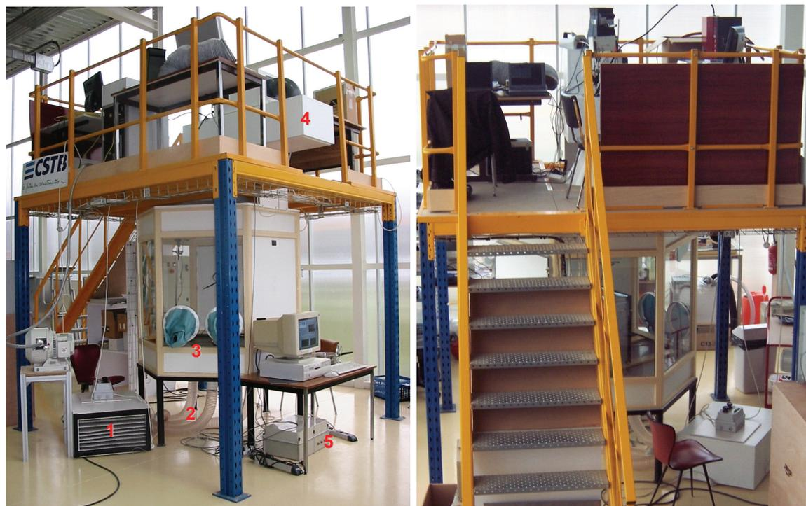
Figure 2-2 : Vues de l'enceinte expérimentale côté gants de manipulation (gauche) et côté escalier d'accès à la plate-forme (droite). 1 : Caisson de filtration (soufflage), 2 : Arrivées d'air filtré, 3 : Gants de manipulation, 4 : Caisson d'extraction, 5 : Poste de suivi des températures.
