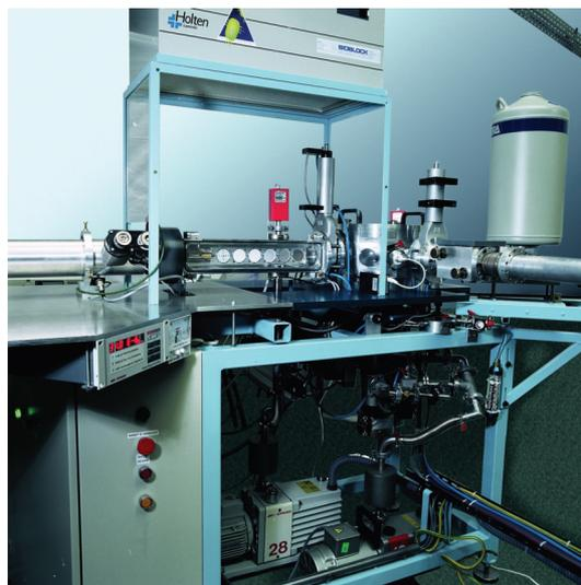
Figure 2-4 : Chambre d'Analyse Rapide des Poussières Atmosphériques.
