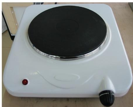
Figure 3-131 : Plaque électrique en fonte utilisée pour les scénarios de cuisson.
