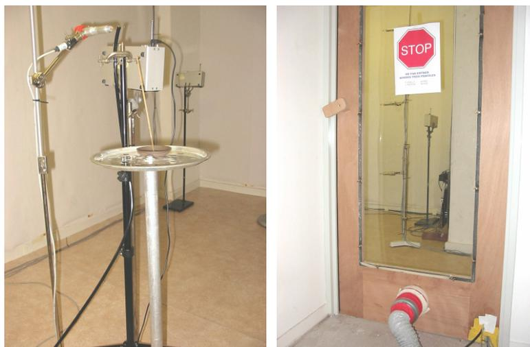
Figure 8 : Vue du prélèvement au centre avec position du point d'injection (à gauche). Vue extérieure de la chambre depuis la fausse porte (à droite).
