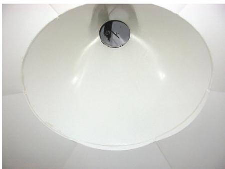
Figure 2-5 : Cône d'accélération permettant d'ajuster la position du point de prélèvement selon la vitesse du flux ascendant d'air pour se rapprocher des conditions d'isocinétisme.
