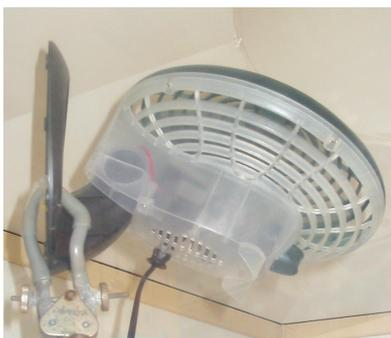
Figure 2-6 : Ventilateur positionné dans l'enceinte destiné à homogénéiser le champ de particules en position haute, au niveau du cône.
