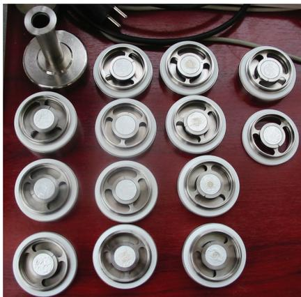
Figure 2-16 : Etages de collecte recouverts de papier aluminium graissé.
