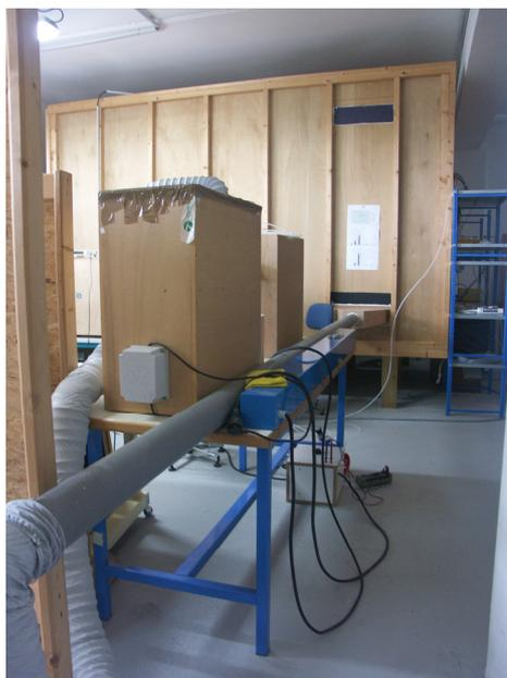
Figure 5 : Système de ventilation «entrée d'air neuf»
