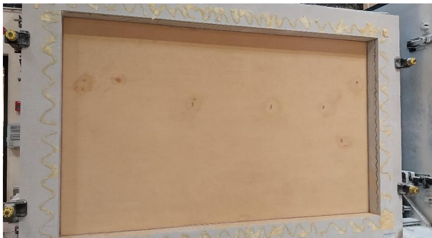
Mur avec enduit en terre fibré dans le poste d'essais côté émission
