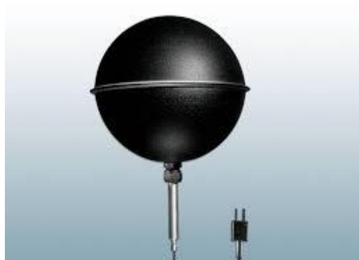
Figure 26 : Globe noir pour la mesure de la température radiante
