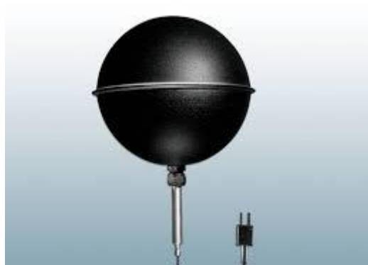
Figure 26 : Globe noir pour la mesure de la température radiante
