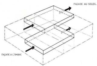
Figure 12 Ventilation naturelle sur la façade exposée.
