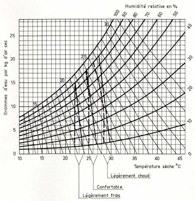
Figure 2 Courbes d'équiconfort.
