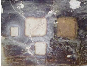
Fig. 11-12. TT 33. Résultats obtenus par microgommage (projection de particules fines) avec de l'oxyde d'alumine à 220 mesh/pression \leq 2 bars, sur une surface de cassure dans la salle II avec différents réglages. Comparaison avec un test chimique réalisé à droite (S. Duberson).
