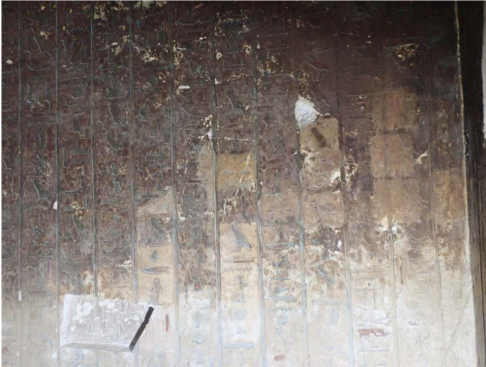
Fig. 9. TT 33. Tests de nettoyages chimiques réalisés en 2017 (salle II, paroi ouest) avec différentes compositions de compresses, en variant les temps de pose et les concentrations de produits actifs employés (S. Duberson).
