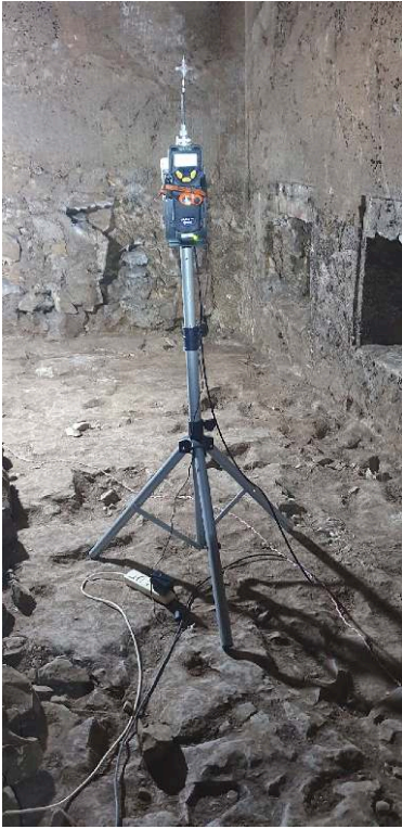
Fig. 22. TT 33. Mesure COV en temps réel : l'appareil (PPB RAE 3000) fixé sur pied permet la mesure et l'enregistrement des valeurs en ppb des COV présents dans le caveau (J. Le Roux, F. Boyer).
