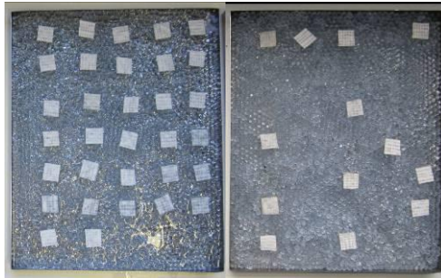
Photographie 5: Plateau contenant de la toile de verre en phase d'humidification (à droite) et de séchage (à gauche)
