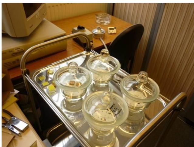
**Photographie 7 : Eprouvettes disposées dans les dessiccateurs**
