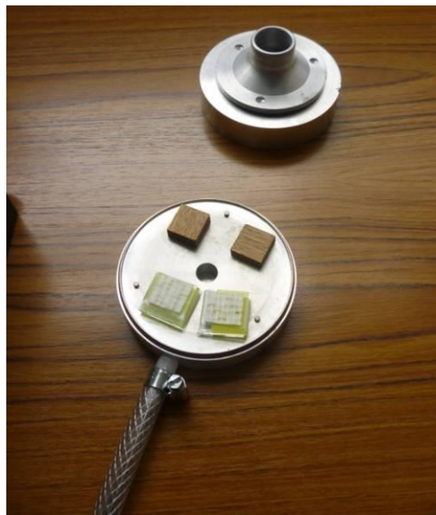
Photographie 6 : Montage de l'impacteur et disposition des coupons de matériaux à contaminer
