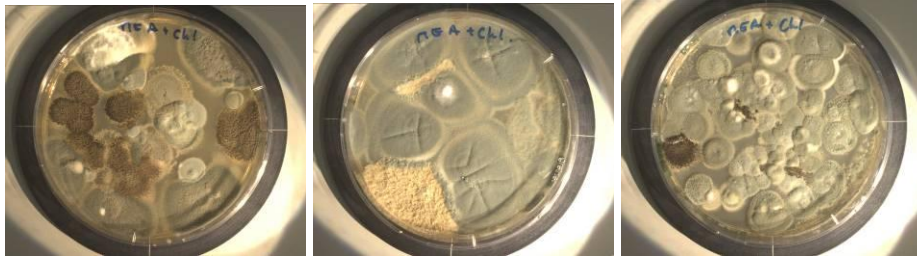
Photographie 15 : Flore fongique observée sur MEA + Chloramphénicol à partir du matériel biologique extrait de coupons de bois après 7 jours d'incubation (de gauche à droite) témoins, traités à l'extrait d'ail et traités à l'huile essentielle de menthe poivrée
