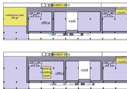
Vue de dessus de 2 niveaux, on remarque les vides en quinconce entre niveaux
