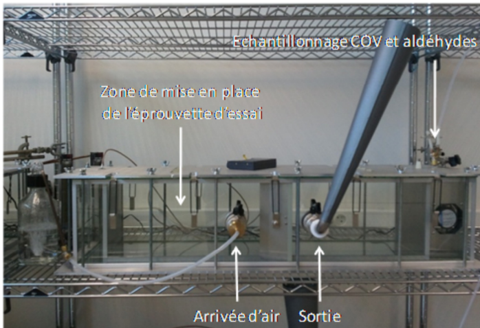
Figure 1 : Chambre d'essais d'émissions
