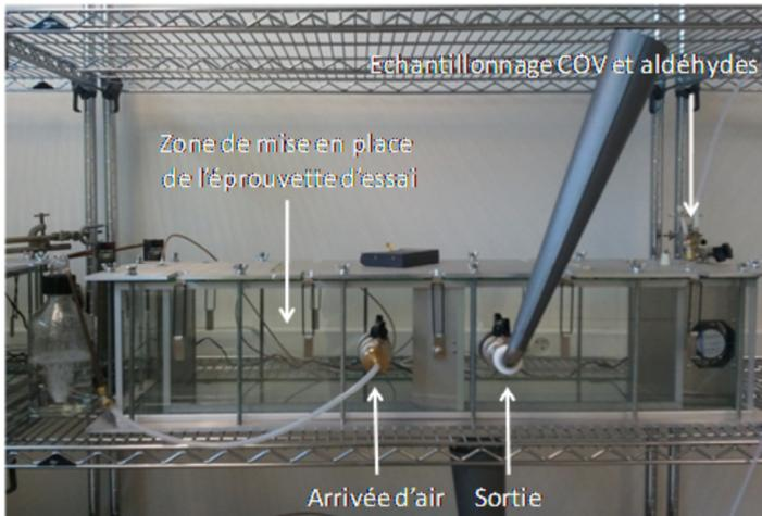
Figure 1 : Chambre d'essais d'émissions
