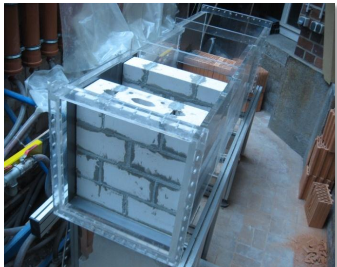
Figure 20 : Principe et banc de tests d'étanchéité à l'eau de maçonnerie (source IOER)
