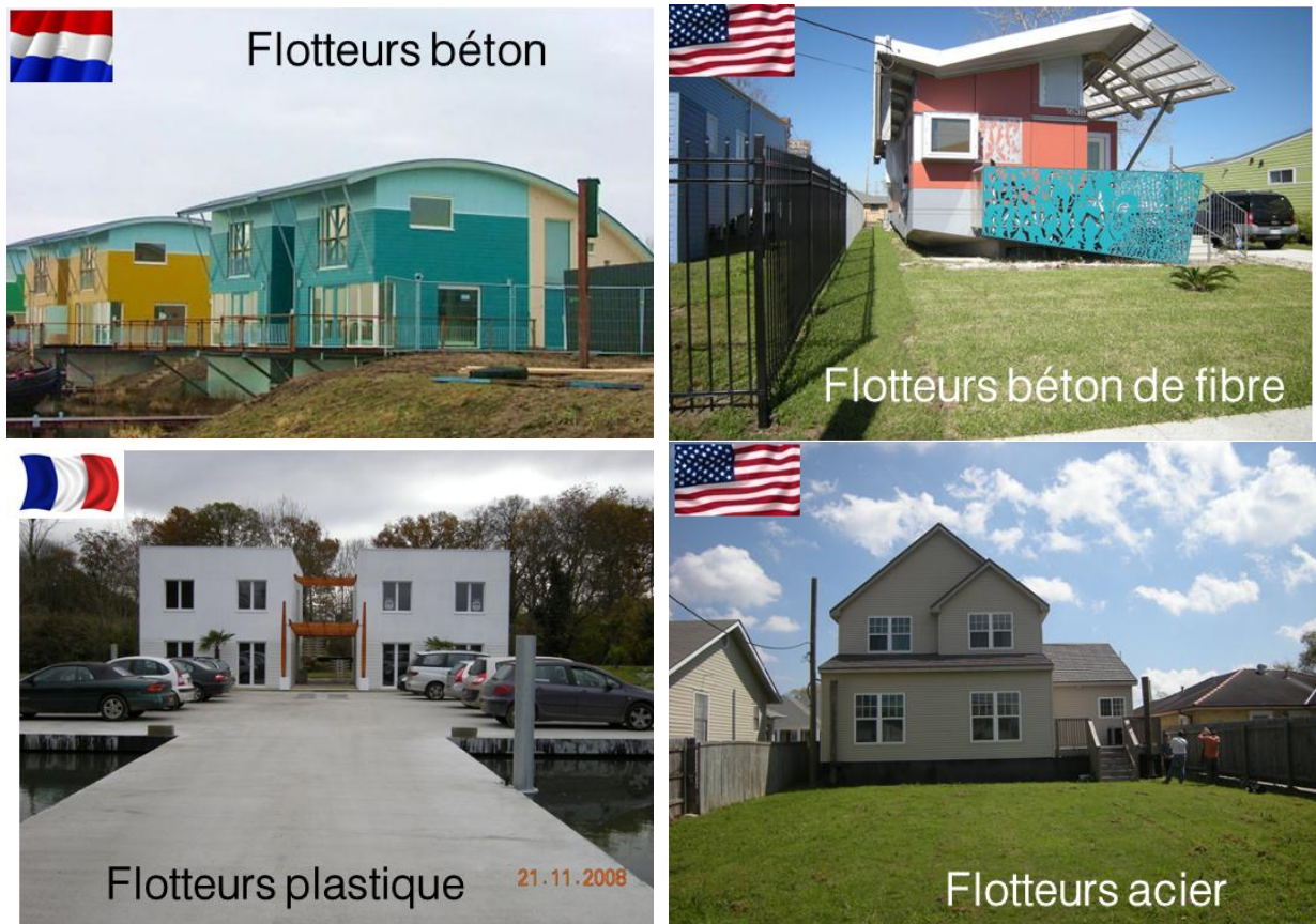
Figure 16 : Exemples de bâtiments amphibies utilisant différents types de flotteurs (photos CSTB)
