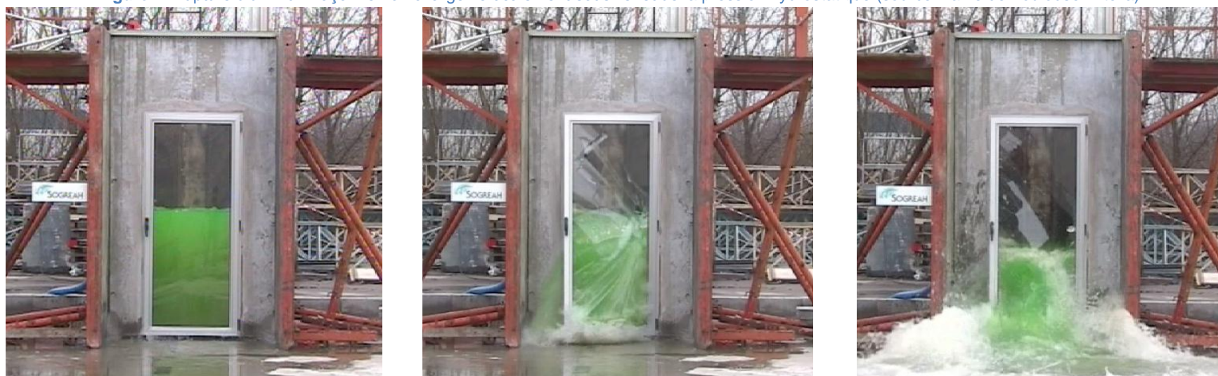
Figure 8 : rupture d'une porte fenêtre sous l'effet de la pression hydrostatique (source Mairie de Toulouse-Artelia)
