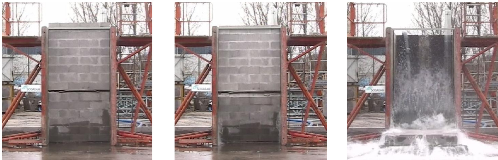
Figure 7 : rupture d'un mur maçonné non chargé verticalement sous l'effet de la pression hydrostatique (source Mairie de Toulouse-Artelia)
