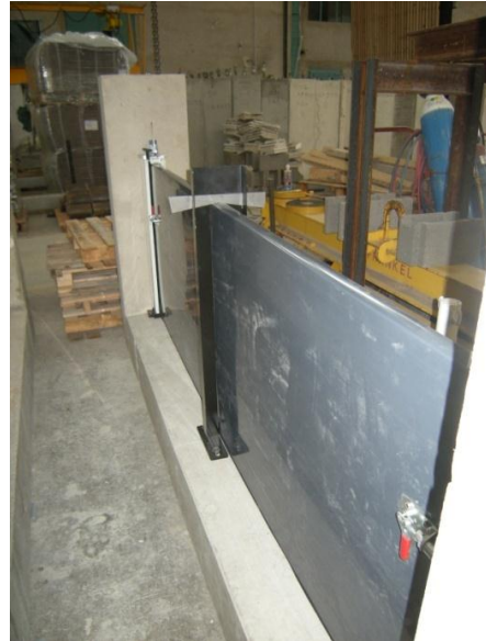
Assemblage de panneaux en PVC (produit Feugier) (photo CSTB)
