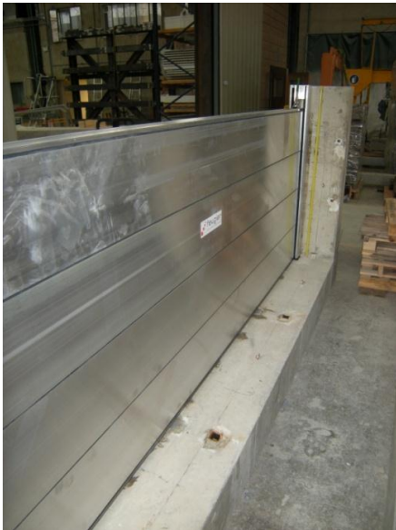
Empilement par emboîtement de planches en aluminium (produit Feugier) (photo CSTB)
