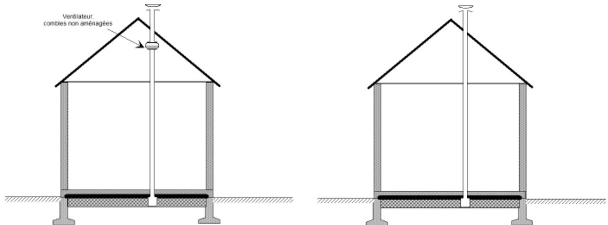
(a) Système actif avec ventilateur d'extraction (b) Système passif sans ventilateur d'extraction
