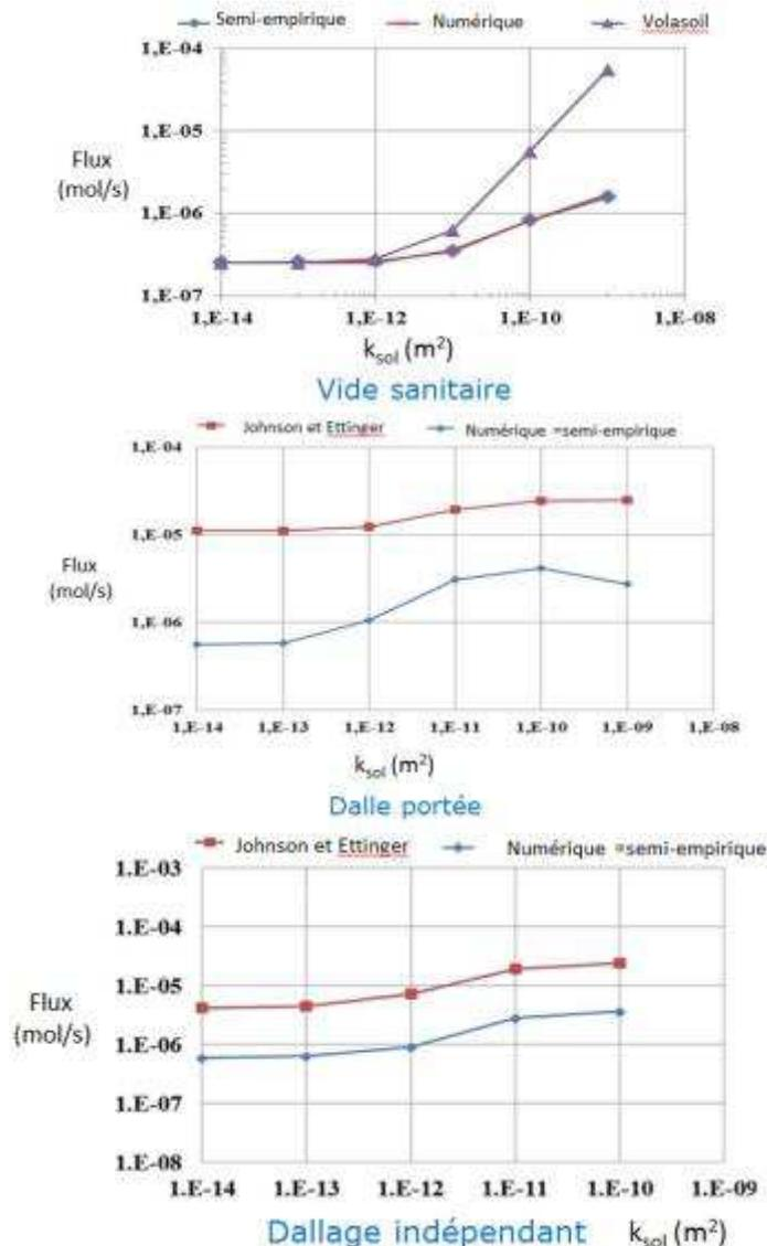
Figure 5 : Comparaison des flux de polluant entrant dans un bâtiment pour les trois typologies (vide sanitaire, dalle portée, dallage indépendant)
