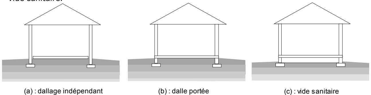
Figure 3 : schéma des types de soubassements
