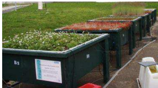
Fig. 7. Bancs expérimentaux végétalisés (projet VegDud)
