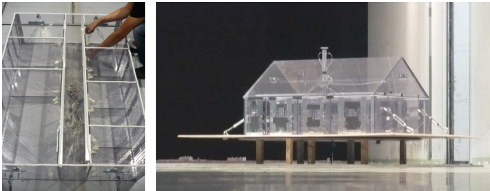
Figure 1 : Instrumentation de la maquette et mise en place dans la soufflerie (2011)
