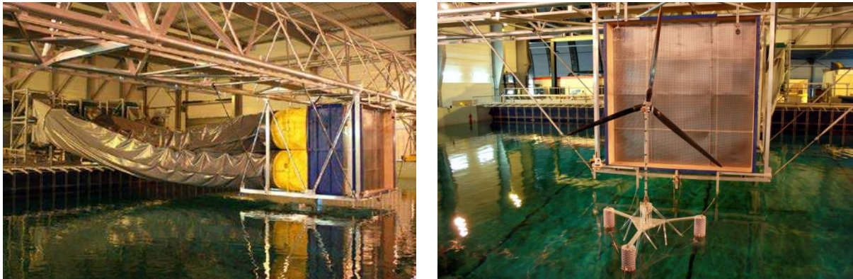
Figure 13 : Réalisation du système de soufflage de simulation du vent off-shore sur le bassin de houle de l'Ecole centrale de Nantes, et test de qualification de la maquette d'éolienne flottante dynamiquement semblable
