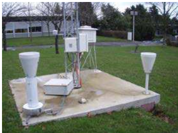
Figure 7 : Pluviomètre hydrostatique - comparaison en site naturel à Nantes
