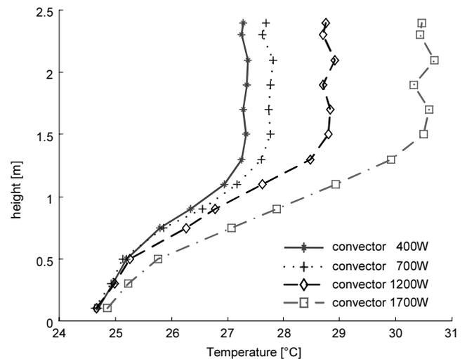
**Figure 9 : Profils de température le long du mur opposé à l'émetteur pour différentes puissances émises**
